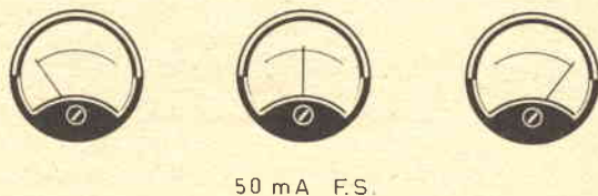
FIG. 5 - Variando la capacità del compensatore C6, si raggiungono le tre condizioni di assorbimento di corrente segnalate in figura. Il punto ottimo è quello raggiunto dall'indice dello strumento centrale.
